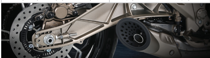
Ενισχυμένο ψαλίδι κράματος αλουμινίου
